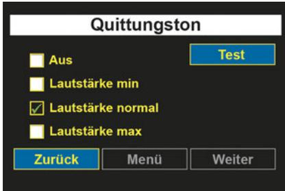
Einstellung der Lautstärke des Quittungstons, der an der Türsprechanlage abgespielt wird.
