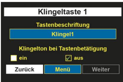
14. Um dem Besucher eine Rückmeldung für das Betätigen einer Klingeltaste zu geben, schalten Sie den „Klingelton bei Tastenbetätigung“ auf „ein“. Die Türsprechanlage spielt dann bei jeder Tastenbetätigung einen Hinweisston über Lautsprecher ein.
