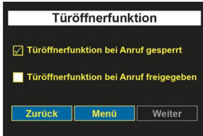
Aus Sicherheitsgründen gegen unberechtigtes Öffnen kann die Tür nicht geöffnet werden, wenn die Verbindung vom Telefon aus zur Türsprechanlage erfolgt. Auf Wunsch kann diese Funktion ausgeschaltet werden.
